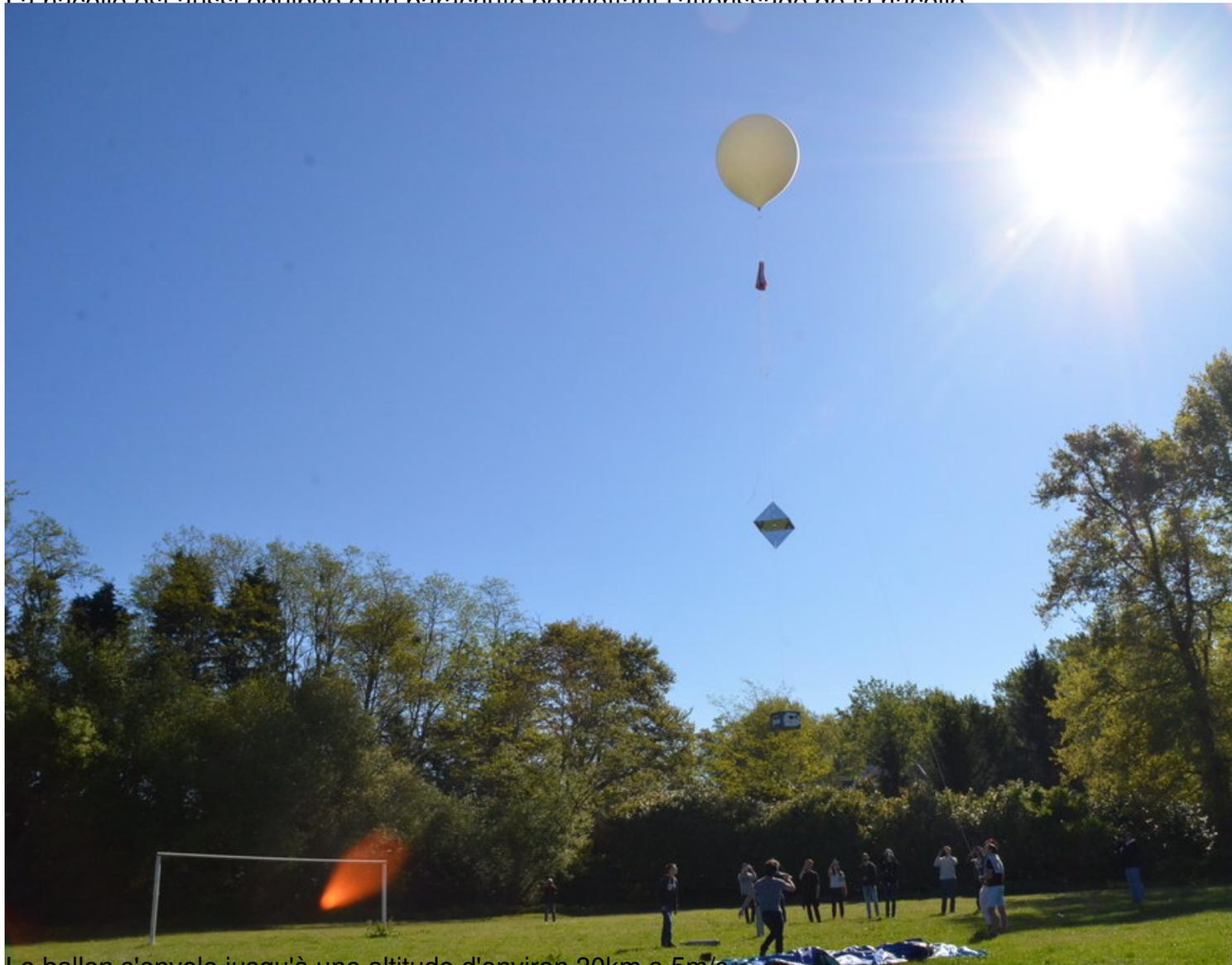
Le ballon s'envole jusqu'à une altitude d'environ 30km à 5m/s.
